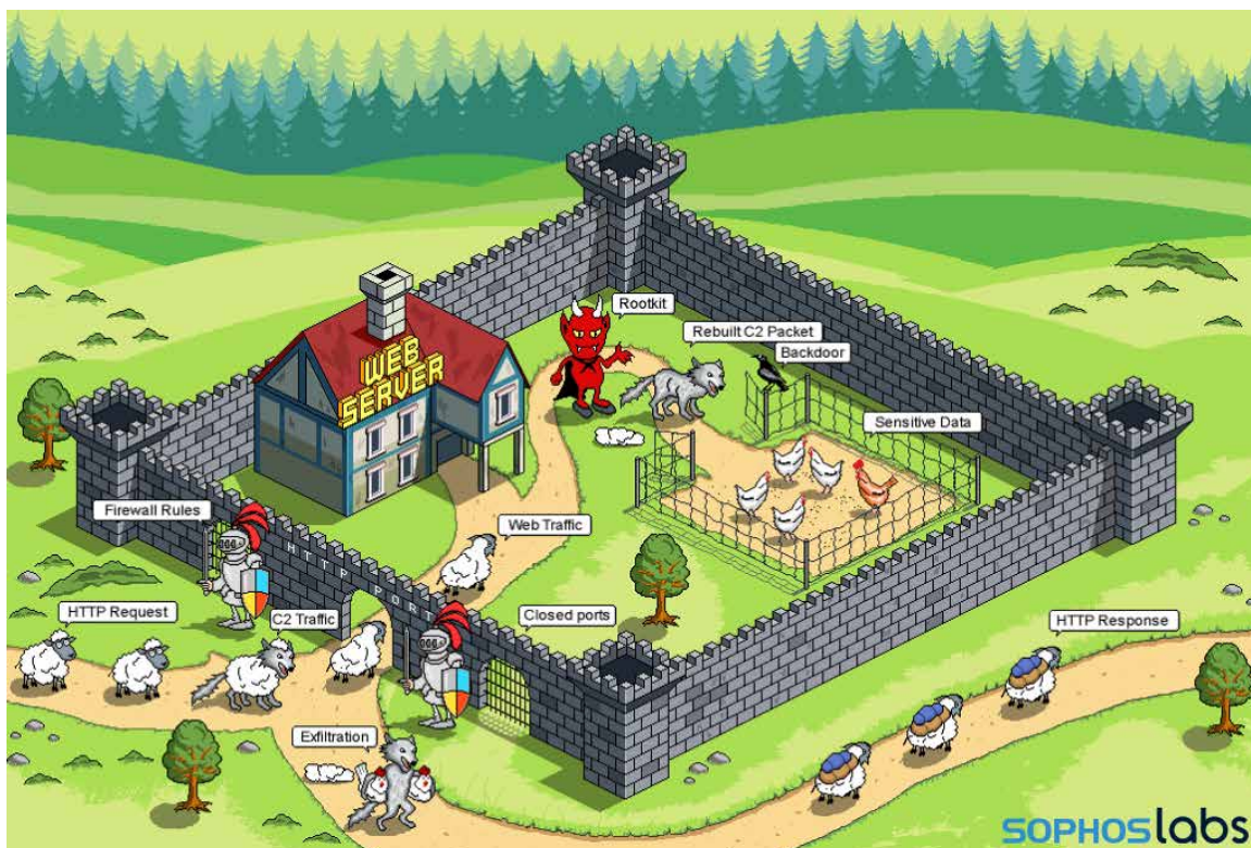
図 4: APT マルウェアの Cloud Snooper を「羊の皮をかぶったオオカミ」にたとえて説明しています。平凡な HTTP リクエストとレスポンスを装い、ネットワークトラフィックを監視してリアルタイムで TCP/IP パケットを書き換えるツールも利用して、自身のコマンドを隠し、データを抽出します。出典：SophosLabs
