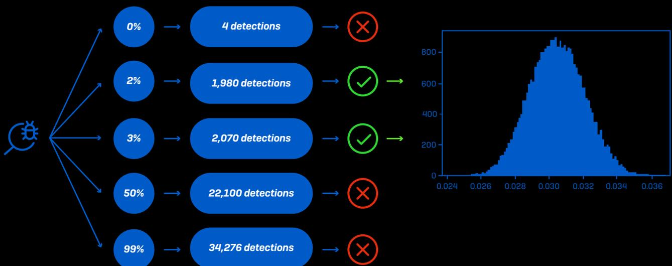
Fig.28. Proporre un tasso di malware, eseguire test, vedere se la simulazione corrisponde alla realtà osservata, annotare i tassi che restituiscono i risultati attesi e ripetere. Fonte: SophosAI.
